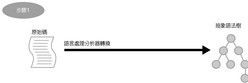
圖4 V8的JIT編譯器直接輸出機器語言 程式語言系統先使用語法分析器將原始碼轉換成抽象語法樹（abstract syntax tree）。之前有幾種方式來處理。位元組碼編譯器將抽象語法樹編輯中間代碼，然後在編譯器中執行。如Java JIT等混合模式將這中間代碼的一部分編輯成機器語言，以改善處理性能。Chrome不使用中間代碼，JIT直接從抽象語法樹來編譯機器語言。也有抽象語法樹編譯器，直接編譯抽象語法樹。
